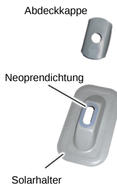
8. Naht (Ø~10 mm) auf angeschliffenen und gereinigten Solarhalter auftragen
